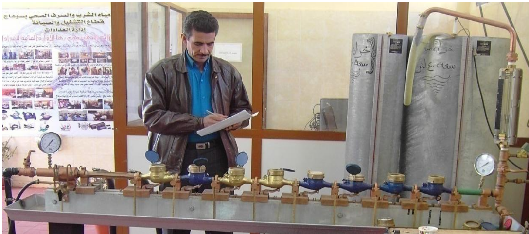
صورة جهاز المعايرة وية عدادات المياه مركبة والتي يتم معايرتها بالمعمل
