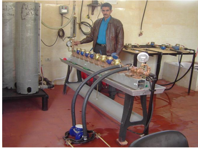
صورة جهاز معايرة العدادات شكل رقم ٢
